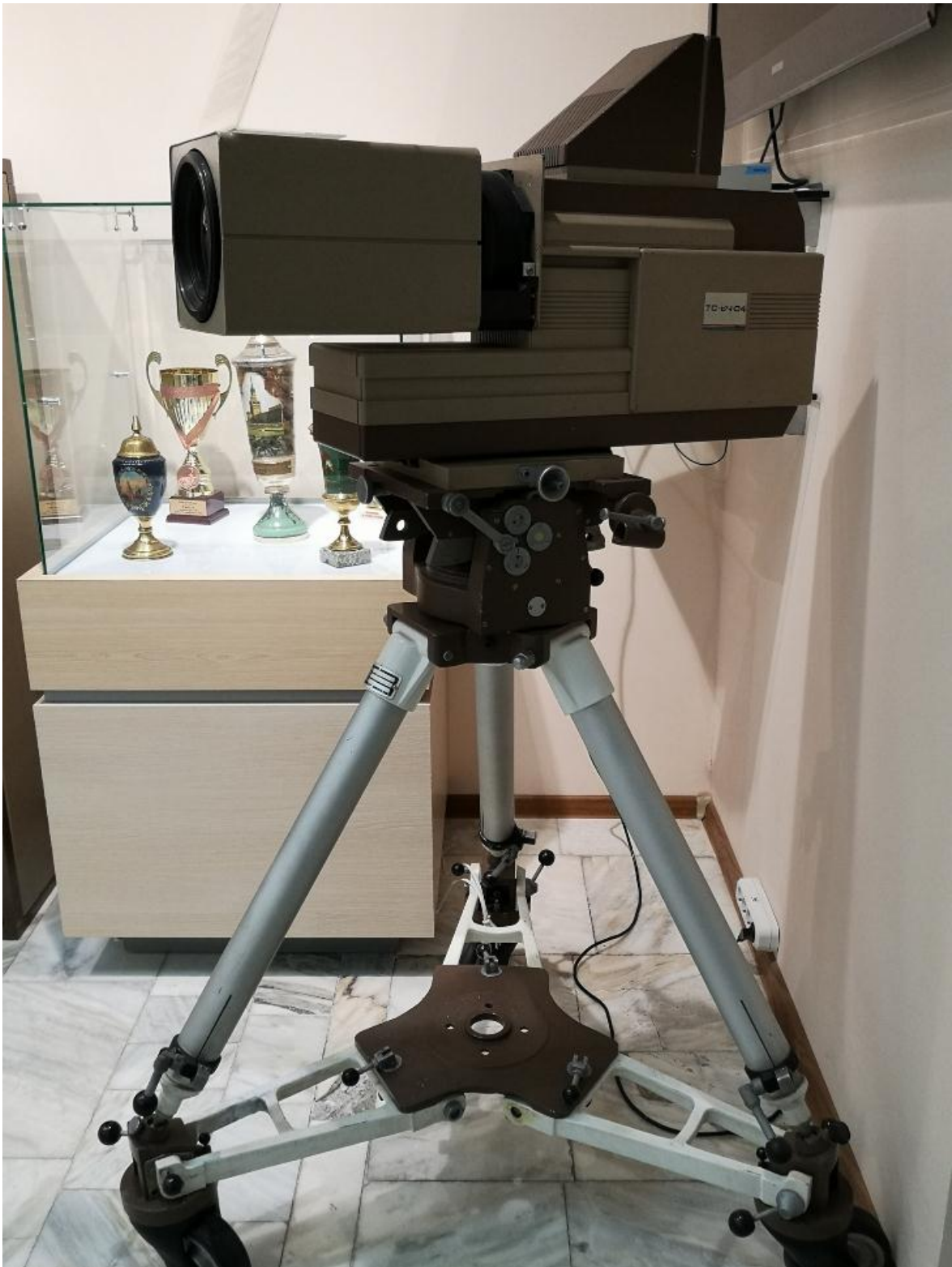
Телевизионная камера ТВЧ ТС-ВЧ 004
