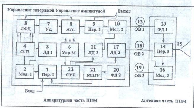
Рис. 7. Схема оптоэлектронного ППМ [48]
