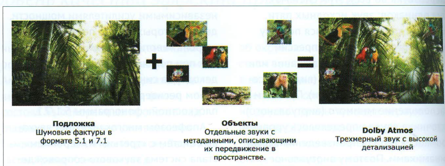
Принцип построения объемной звуковой сцены в системе Dolby Atmos
